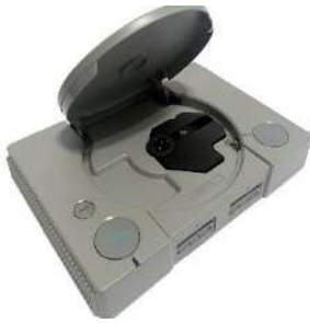
Figura 12. Consola PlayStation abierta para apreciar el lector de discos (Game Troop, 2020).
